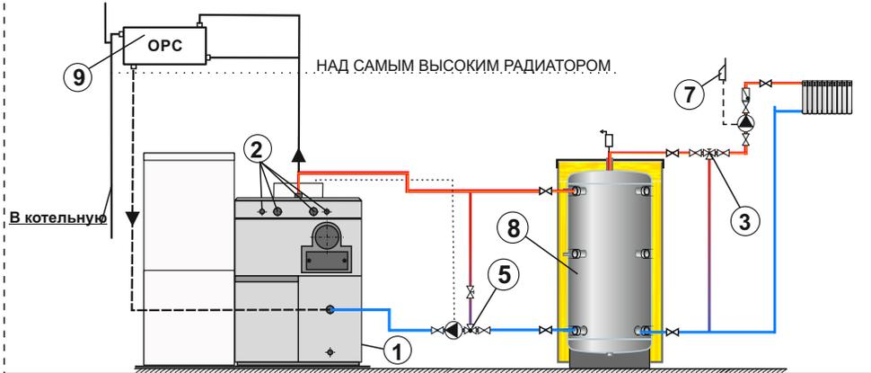
**Схема 3б.** Пример, когда по норме EN 303-5 не нужно подключение буферного накопителя к системе отопления
