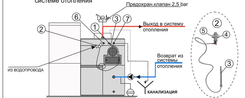
\* Положение термического вентиля после монтажа:
