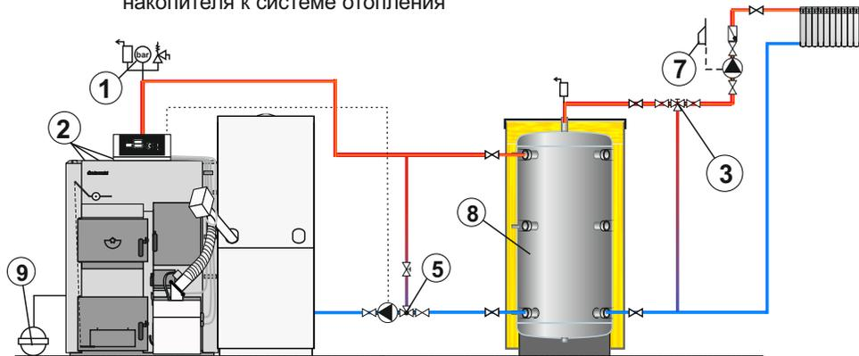
**Схема 1б.** Пример, когда по норме EN 303-5 не нужно подключение буферного накопителя к системе отопления
